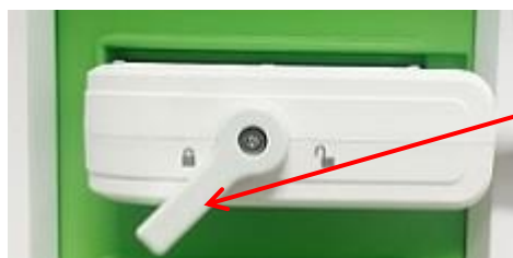
Figura 28: Orientação do conector do transdutor
