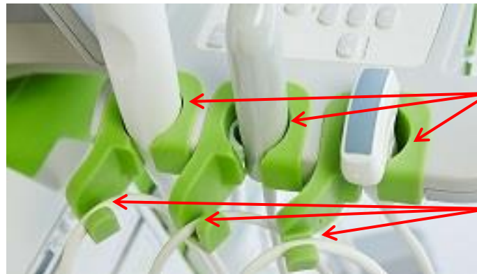
Figura 36: Suportes de transdutor/gel e guias de cabos
