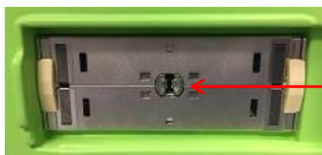
Figura 27: Entalhe de bloqueio na ranhura do conector do transdutor
