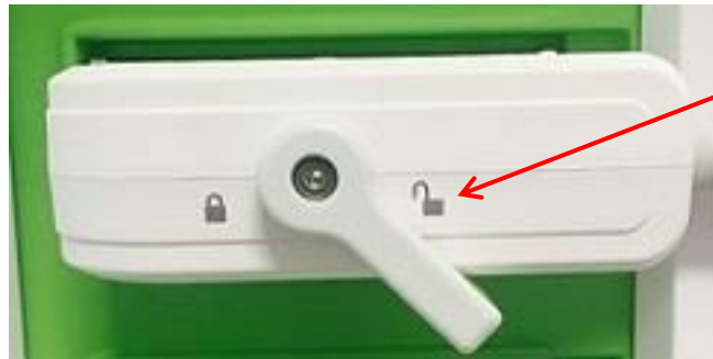
Figura 29: Botão de bloqueio do conector do transdutor desbloqueado
